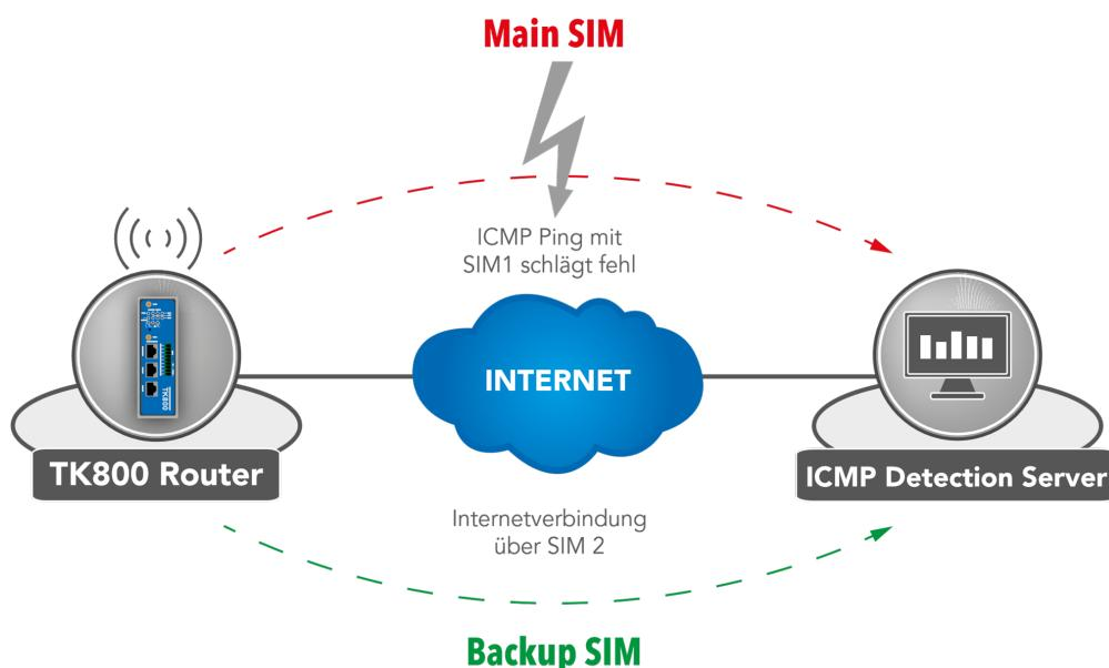
Bei Ausfall eines Providers wird auf den Alternativprovider umgeschaltet. Gleiches gilt bei Verbrauch des mobilen Datenvolumens. Der TK 800 überwacht dabei mittels ICMP die Datenverbindung. Steht diese nicht mehr zur Verfügung (weil der Ping fehlschlägt) schaltet der Router auf die andere Verbindung um.
