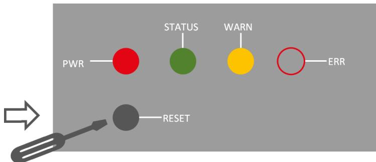
2) Sobald die LED-Leuchte ERROR aufleuchtet (ca. 10 Sekunden nach dem Einschalten), lassen Sie die RESET Taste los:
