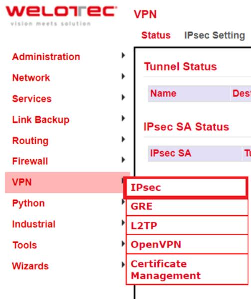
Von hier aus stehen Ihnen die Möglichkeiten „IPsec Setting“ und „IPsec Extern Setting“ zur Verfügung.
