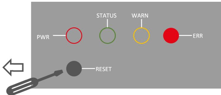
3) Nach einigen Sekunden leuchtet die LED-Leuchte ERROR nicht mehr. Nun drücken Sie erneut die RESET Taste bis die Error Leuchte blinks und lassen die Taste dann los:
