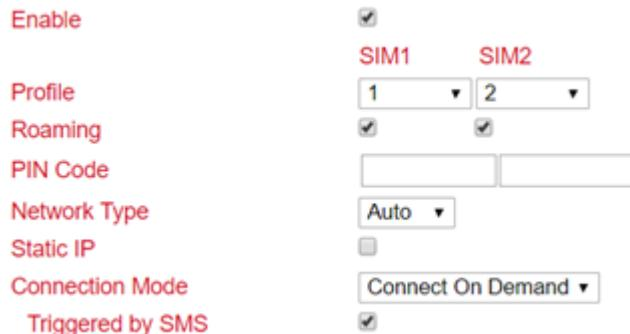
3. Wählen Sie hier unter **Connection Mode** den Modus **Connect On Demand** aus und aktivieren Sie das Feld **Triggered by SMS**. Nun können Sie folgende Befehle per SMS an den Router senden:
